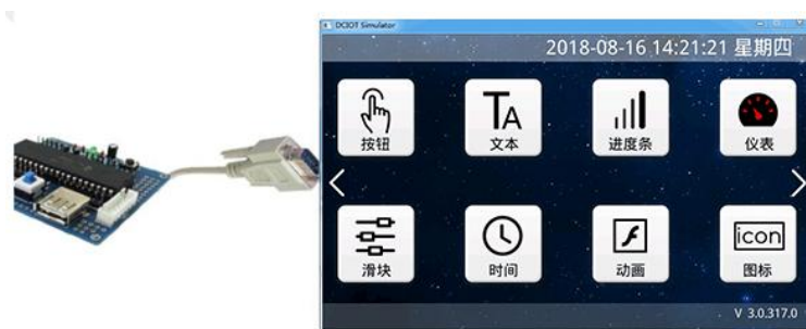
图 8-2 用户单片机串口与“虚拟串口屏”联机调试
